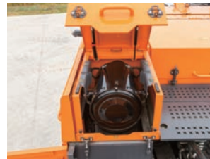
Heavy Duty 에어클리너 기본 에어클리너에 사이클론 형태의 에어클리너를 추가하여 공기의 여과 효율 증대
