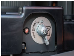
배터리 차단 스위치 램프 장비보호를 위해 상태표시 램프가 적용된 배터리 차단 스위치 (램프 점등 시 배터리 차단 금지)
