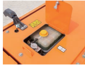
리저브 탱크 레벨 센서 냉각수 부족 시 모니터에 알람 제공 냉각수 주입성 증대
