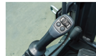
조이스틱 썸힐 스위치 조이스틱 썸힐 버튼으로 1way, 2way 및 Rotating 조작
