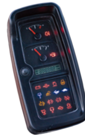
아날로그 통합 게이지 패널 장비 정보 확인 가능한 통합 계기판
