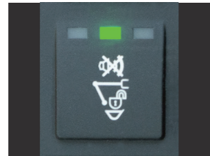
퀵플러 부저 On/Off 기능 NEW* 퀵플러 부저 On/Off 기능을 탑재하여, 소음으로 인한 현상 불만 해소
