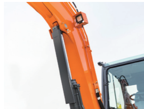
붐 실린더 보호 커버 내구성 증대 붐 실린더 커버 두께 증대를 통한 내구성 향상
