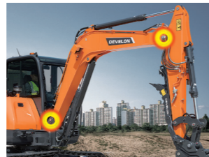
프론트 면압 및 내마모 증대 붐 핀 부위에 내마모 성능이 우수한 EM 부시 적용, 주요 핀 부상 사이즈 증대로 프론트 유격 개선 및 내구성 향상
