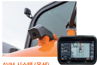
AVM 시스템 (옵션) 5가지 View Mode를 통해 시각지대의 시야를 캐빈내 모니터로 확인하여 보다 안정된 작업 가능
