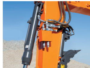
프론트 배관 형상 최적화 NEW 프론트 배관 형상 최적화를 통한 파손 방지
