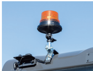
경광등 위치 개선 NEW 경광등 위치 개선을 통한 파손 방지
