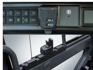
마이크로폰 & 다단 도어 기능 외부 작업자와 의사 전달을 위한 마이크로폰과 위치별 멈춤이 가능한 기능 도어 적용
