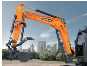
붐 내부 보강으로 내구성 증대 붐 주요 부위 보강 및 강성 증대를 통한 내구성 향상
