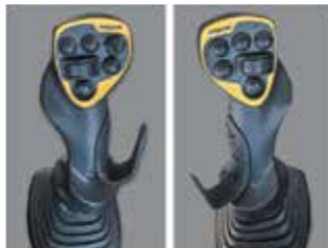
조이스틱 조향 (옵션) 조이스틱에서 손을 떼지 않고 좌/우 조향이 가능하며 작업편의성 향상 (앵콘 틸트로테이터 옵션 선택 시 적용)
