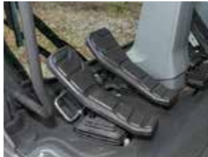
새로운 디자인의 페달 인체공학적 설계로 페달각도 및 형상을 설계하여 조작 편의성 증대
