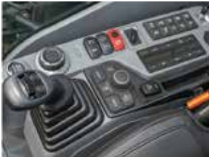
통합 키패드 조작이 편리한 신규 디자인의 키패드 적용하여 스위치 접근성 및 조작 편의성 증대
