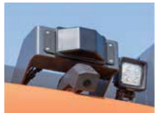
Radar 최대감지거리 6M의 레이더 센서 적용으로 안전성 증대
