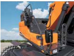
우측 사이드뷰 NEW 카메라 위치변경 파손 방지를 위한 위치변경 및 높이/각도 조절기능 추가
