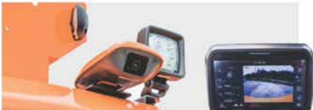
AVM 시스템 하늘에서 보는 듯한 Top View, 우측방 사각지대를 해소하는 Top+Rear View 등 5가지의 View Mode를 지원하여 보다 안전한 작업이 가능 (AVM옵션 미 선택 시 후방카메라 적용)
