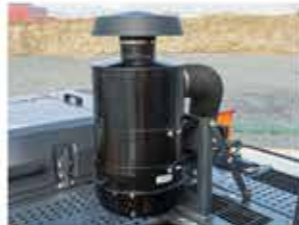
습식 크리너 분진이 많이 발생하는 작업 환경을 위한 습식 크리너 표준 장착
