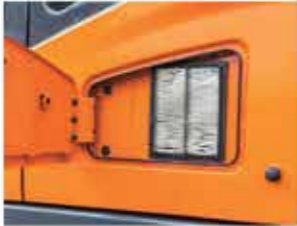
에어컨 공기 청정 필터 실내 공기 청정 필터는 손쉬운 청소 및 교환이 가능하도록 외부에 설치
