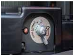
배터리 차단 스위치 램프 장비보호를 위해 상대표시 램프가 적용된 배터리 차단 스위치 (램프 점등 시 배터리 차단 금지)
