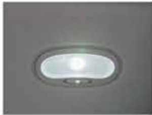
도어 연동 실내 램프 운전실 도어 개폐 상태에 따라 실내 램프 자동 on / off
