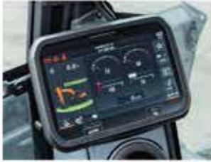
8인치 터치식 계기판 8인치 LCD 터치스크린 모니터 적용으로 조작 편의성 및 시인성 개선
