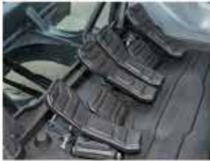
인체공학적 디자인의 페달 인체공학적 설계로 페달각도 및 형상을 설계하여 조작 편의성 우수
