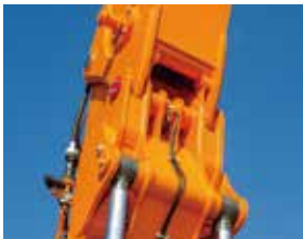
유압핀 조인트 시스템 유압실린더를 이용한 자동 핀 / 분해 장치
