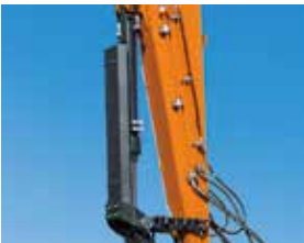
버킷 실린더 가드 엔드암에 가드를 적용하여 외부 충격으로 인한 실린더 파손 방지
