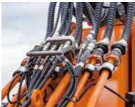
프론트 호스 커플러 시스템 호스 커플러 시스템 적용으로 호스 탈거 / 조립이 용이
