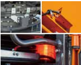
작업반경 위험 알람 (스윙, 붐 각도) 붐 및 스윙 앵글 센서가 장착되어 붐 하강 및 스윙 중 안전작업 범위를 벗어나면 알람 제공
