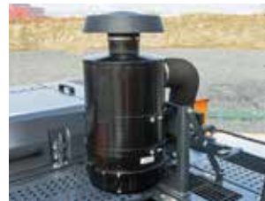
습식 크리너 분진이 많이 발생하는 작업 현장을 위한 습식 크리너 표준 장착
