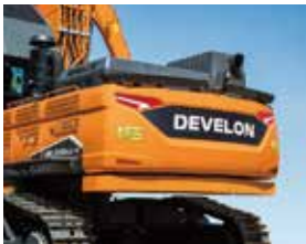
보조 카운터 웨이트 기본 카운터 웨이트에 보조 카운터 웨이트 적용하여 더욱 안정적인 작업 가능
