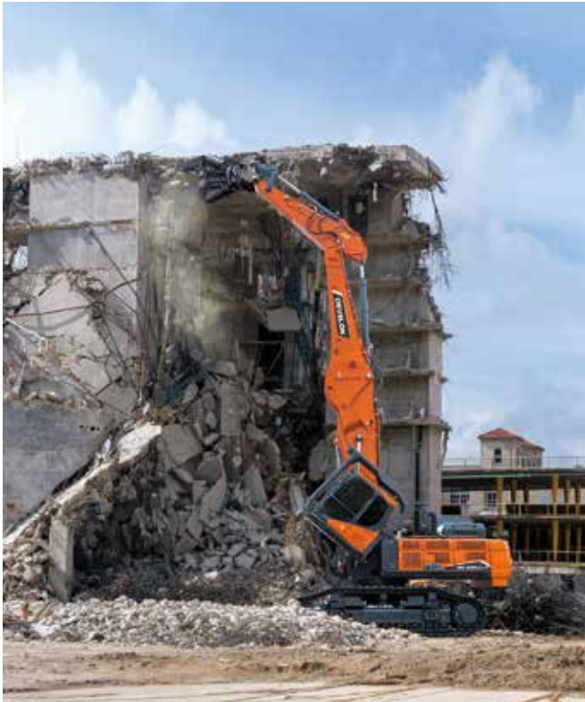
철거 가능 높이 17m : 디깅 Front 스트레이트 방식 장착 시 토목장비로 활용 가능 : 붐 꺾었을 시 장착 가능 옵션 38톤 급 킥클램프, 크라샤, 버켓
