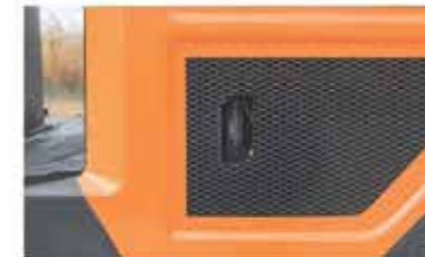
연료 게이지 연료 잔량 확인이 가능하도록 장비 측면에 연료 게이지를 적용하여 연료 주입 시 편의성 증대
