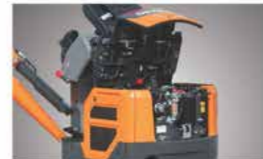
풀 오픈 타입 엔진룸 엔진 관련 부품의 일상 정비가 용이한 풀 오픈 타입의 엔진룸 적용
