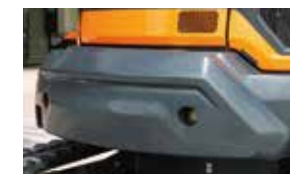
증량된 보조 카운터 웨이트 (DX35Z-7) NEW 보조 웨이트 증량을 증대하여, 인양 성능 및 안정도 향상
