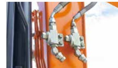
회전 배관 기본 장착 어태치먼트를 장착 하여 장비 활용성 확대
