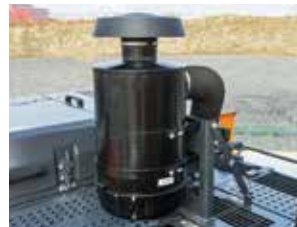
습식 크리너 분진이 많이 발생하는 작업 현장을 위한 습식 크리너 표준 장착
