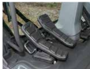
새로운 디자인의 페달 인체공학적 설계로 페달각도 및 형상을 설계하여 조작 편의성 증대
