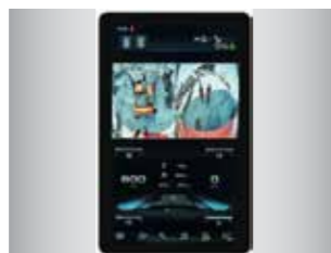
스마트 AVMS (옵션) 장비 주변의 360° 상황을 한 눈에 볼 수 있으며 장비 주변의 사람만 감지하여 알람 제공
