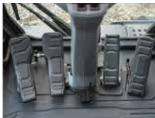
오토홀드 브레이크 작업 중 차속이 0 km/h이 되면 자동으로 브레이크가 작동하고 가속페달 조작 시 자동해제
