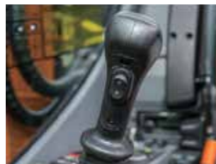
조이스틱 핫 키 작업 중 조이스틱에서 손을 떼지 않고 전 / 후진 기어변속 및 램락 실린더 작동
