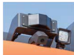
Radar Radar 센서 적용으로 최대 감지 거리 및 센싱 속도 향상되어 안전성 증대
