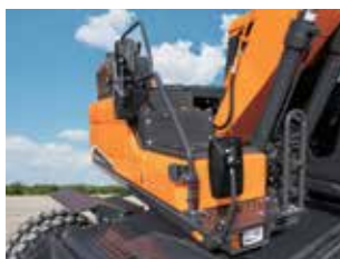
우측 사이드뷰 NEW 카메라 위치변경 파손 방지를 위한 위치변경 및 높이 / 각도 조절기능 추가
