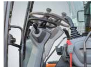
신규 텔레스코픽 조향 컬럼 핸들의 높이 및 틸팅각도 조정 가능 신규 디자인 적용으로 두께가 축소되어 전방 시야성 및 거주편의성 개선
