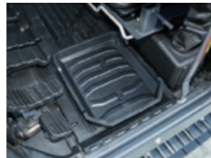
신발 보관함 러버 재질의 신발 보관함을 적용 하였으며 매트에 고정 돌기로 이탈 방지
