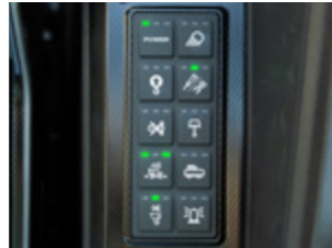
Key - Pad 타입 스위치 Key - Pad 스타일의 스위치 적용으로 빠르고 편리한 작업선택 가능
