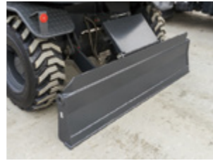
도저 블레이드 형상 최적화 도저 블레이드 형상 최적화로 장비 안정성 증대 및 변형 최소화
