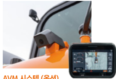
AVM 시스템 (옵션) 5가지 View Mode를 통해 사각지대의 시야를 캐빈내 모니터로 확인하여 보다 안정된 작업이 가능
