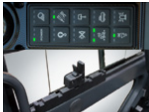
마이크로폰 & 다단 도어 기능 외부 작업자와 의사 전달을 위한 마이크로폰과 위치별 멈춤이 가능한 기능 도어를 적용
