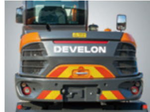
본넷 침술 장착 구조 디자인 침술 장착 구조로 디자인을 고급화, LED Bar 타입의 보조 제동등 적용으로 시인성 향상
