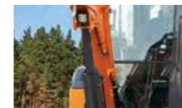
스프링 타입 붐 실린더 보호커버 원복이 가능한 스프링 타입으로 고된 작업 환경에서의 파손 예방
