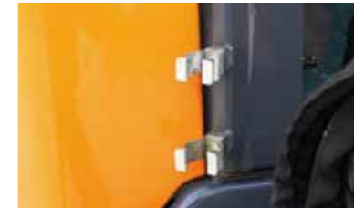
구리스건 거치대 캐빈 전방 우측에 거치하여 언제 어디서나 편리한 정비 환경 조성
