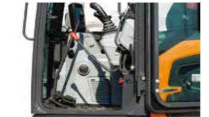
출입구 폭 증대 스탠드 틸팅 각도 증대를 통해 출입구 폭을 증대하여 캐빈 출입 및 탑승 환경을 보다 편리하게 조성
