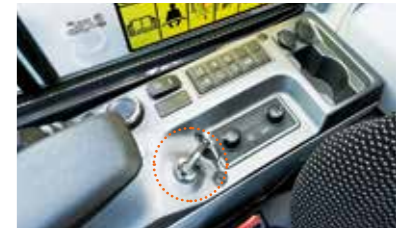
수분 유입 방지 키 수분 유입을 차단하는 디자인의 키를 적용하여 장비 이상 및 고장 방지
