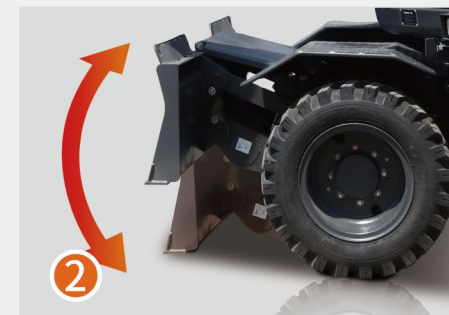
2. 推土铲&推土铲油缸护板(选配)
