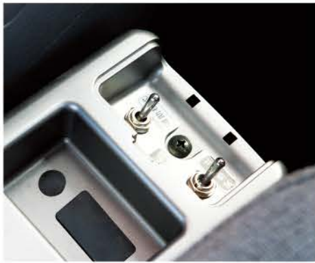
增加发动机紧急熄火开关
