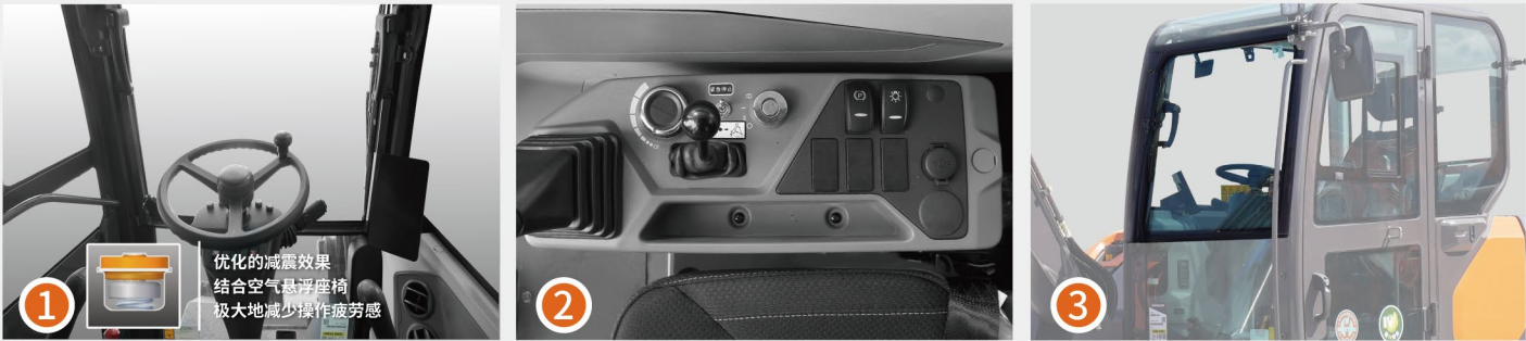
1.驾驶室空间加大、内饰升级 2.集中化的开关设计、便利的储物空间 3.标配前方滑动门
