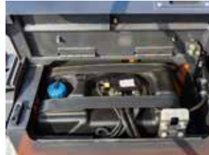
접근성이 용이한 우레아 탱크 Full Open 방식의 커버 및 레벨램프 적용으로 주입성 증대
