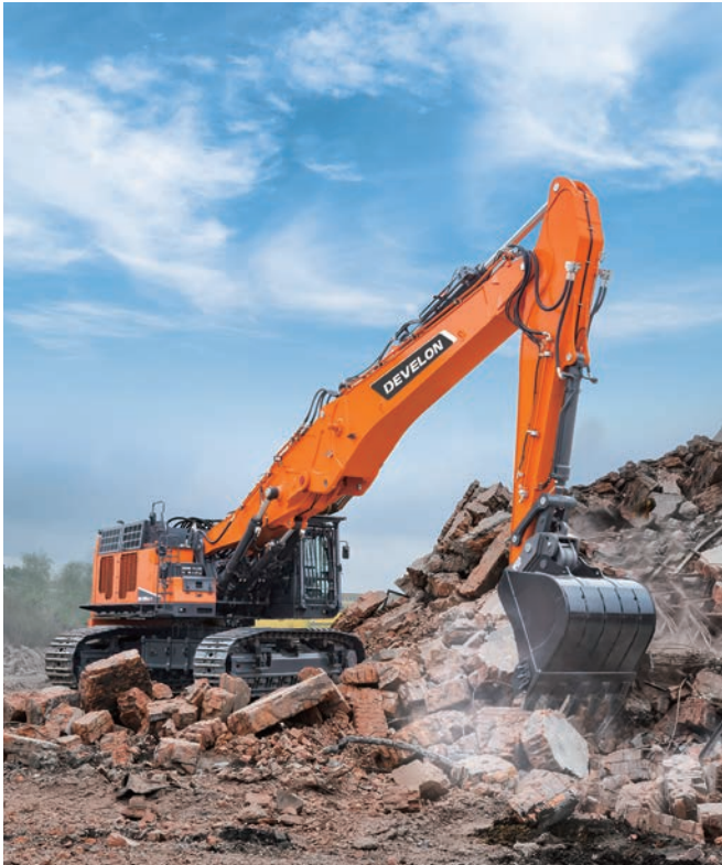
철거 가능 높이 19m : 디깅 Front 스트레이트 방식 장착 시 토목 장비로 활용 가능·붐 벤딩 시 장착 가능 옵션 55톤급 콕클램프, 크라샤, 버켓
