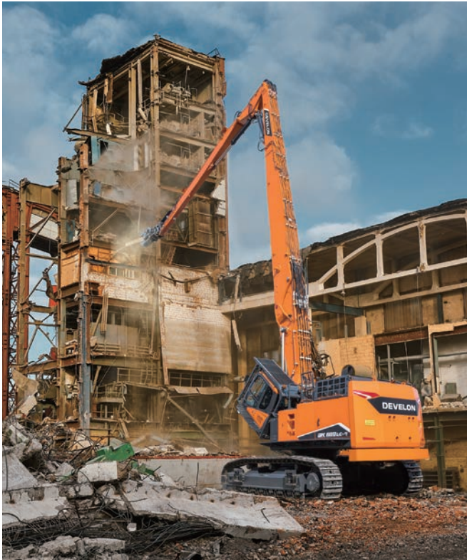
철거 가능 높이 36m : Only 데몰리션 Front 장착 가능 옵션 30톤급 콕클램프, 크라샤
