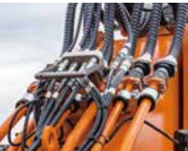
프론트 호스 커플러 시스템 호스 커플러 시스템 적용으로 호스 탈거 / 조립이 용이
