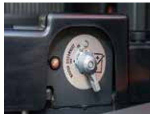
배터리 차단 스위치 램프 장비보호를 위해 상태표시 램프가 적용된 배터리 차단 스위치 (램프 점등 시 배터리 차단 금지)
