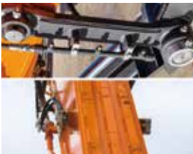
Water Spary 시스템 먼지가 많은 현장을 위한 물 분사 장치
