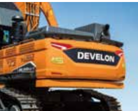
보조 카운터 웨이트 기본 카운터 웨이트에 보조 카운터 웨이트를 적용하여 더욱 안정적인 작업 가능
