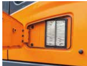
에어컨 공기 청정 필터 실내 공기 청정 필터는 손쉬운 청소 및 교환이 가능하도록 외부에 설치
