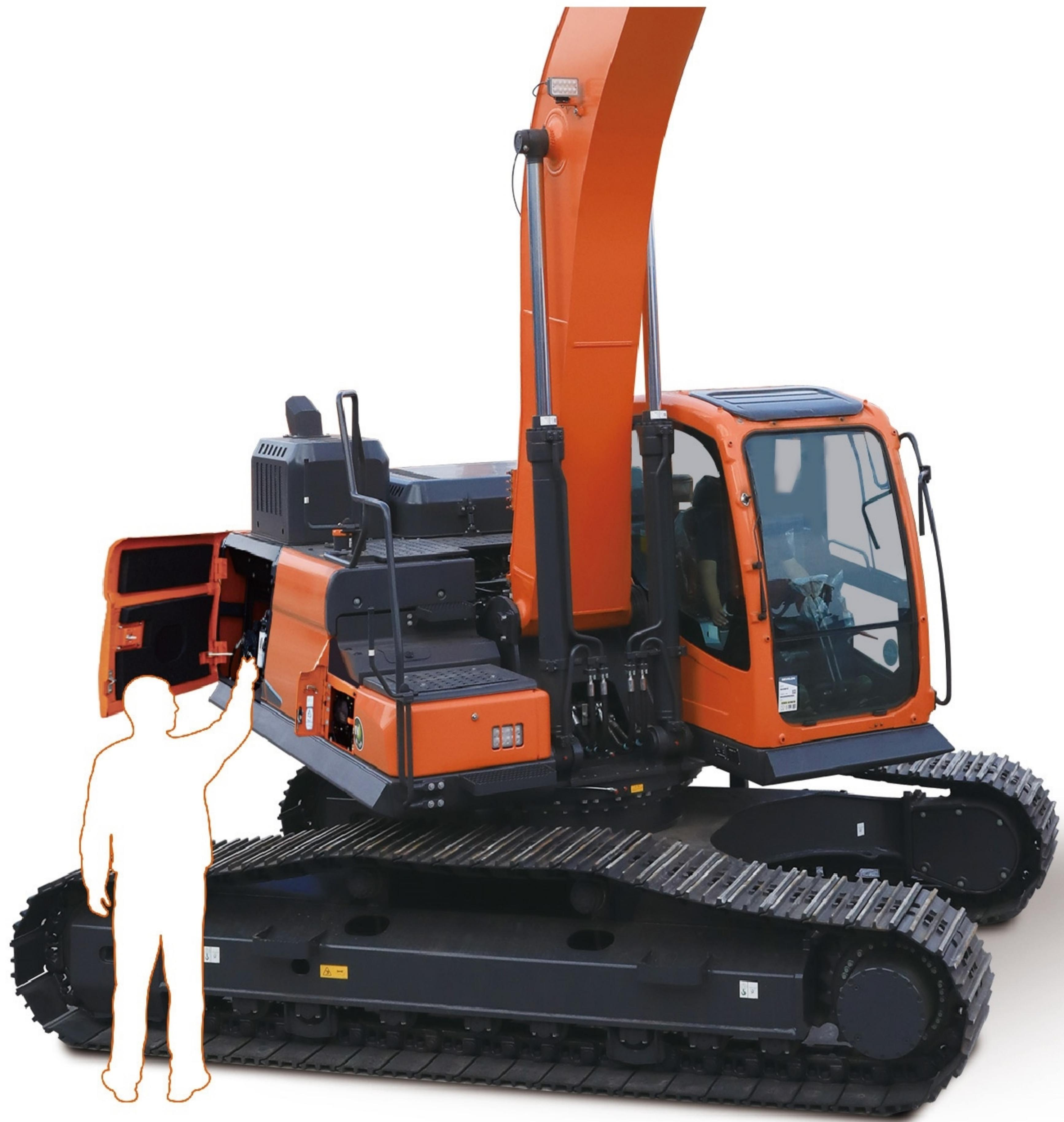
驾驶室侧维修通道滤芯集中布置, 增加维修的便利性。
