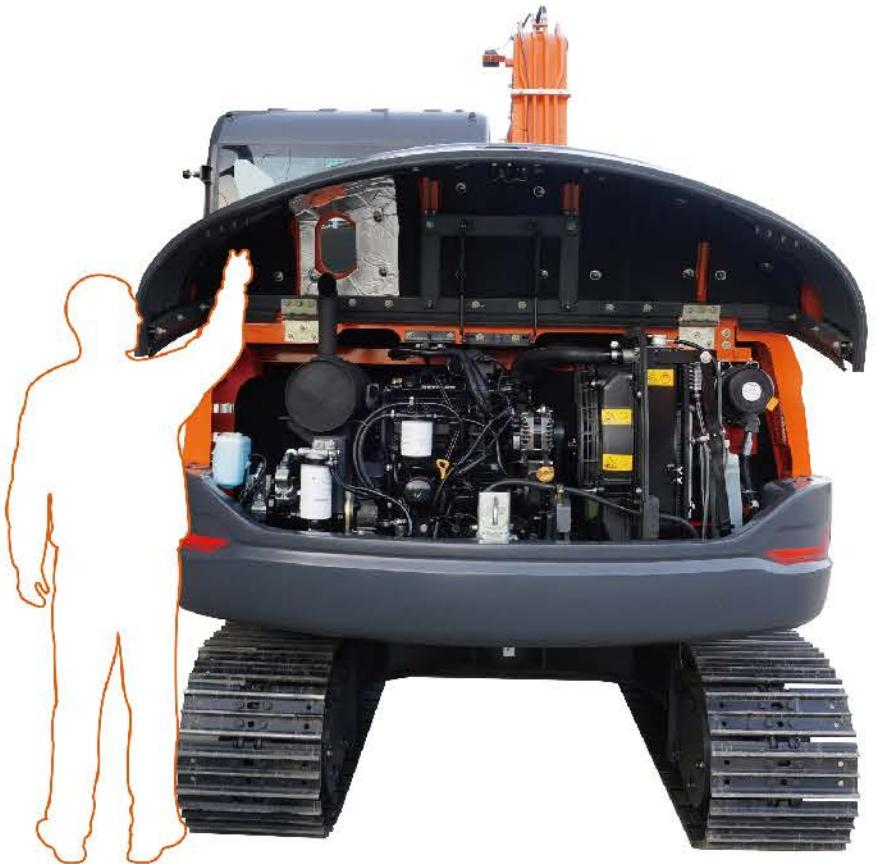
新设计牢固稳定的黄油桶支架,以及人性化的上车扶手和脚踏,方便上车维修保养和加注燃油。
