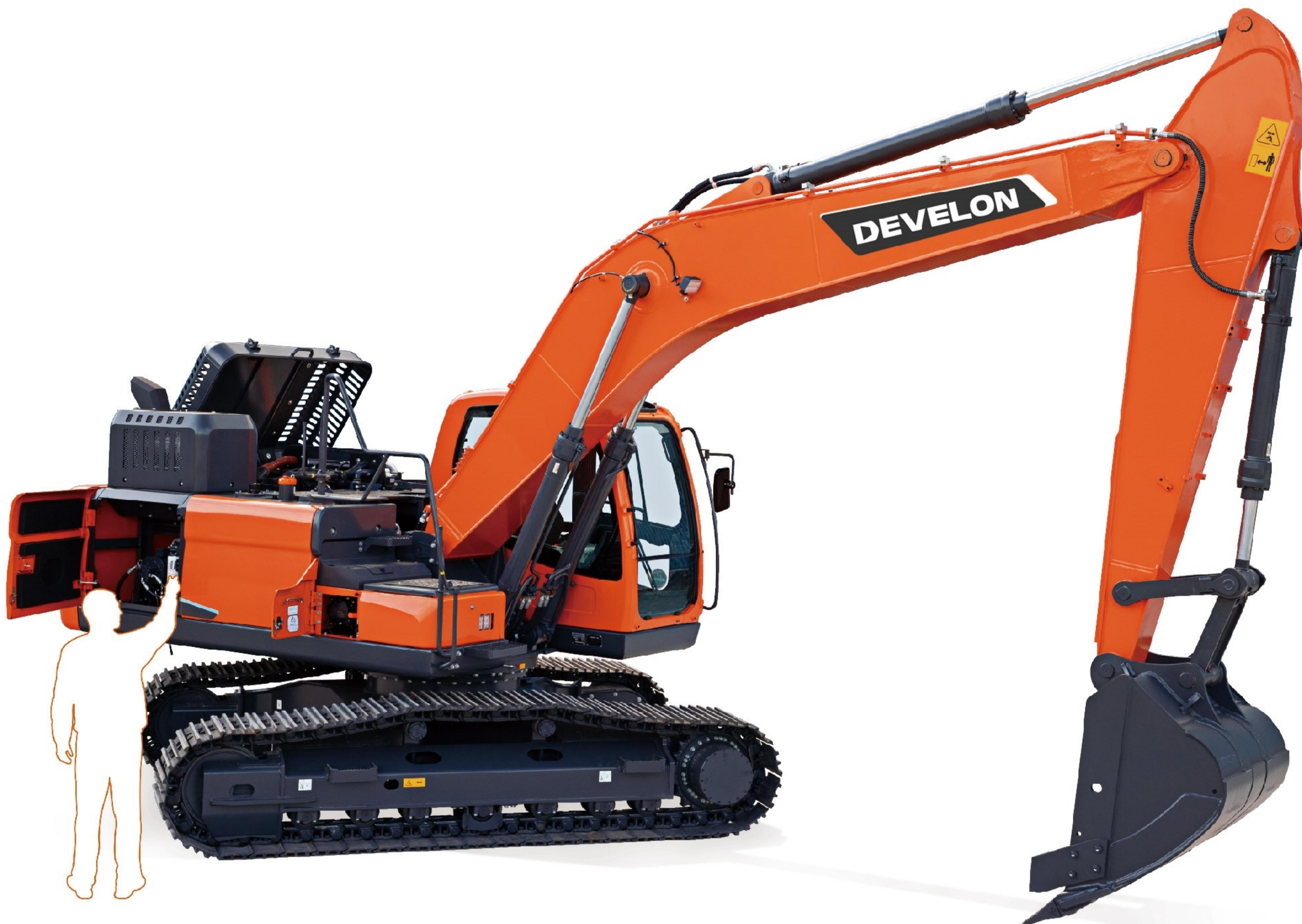
驾驶室侧维修通道滤芯集中布置,增加维修的便利性。
