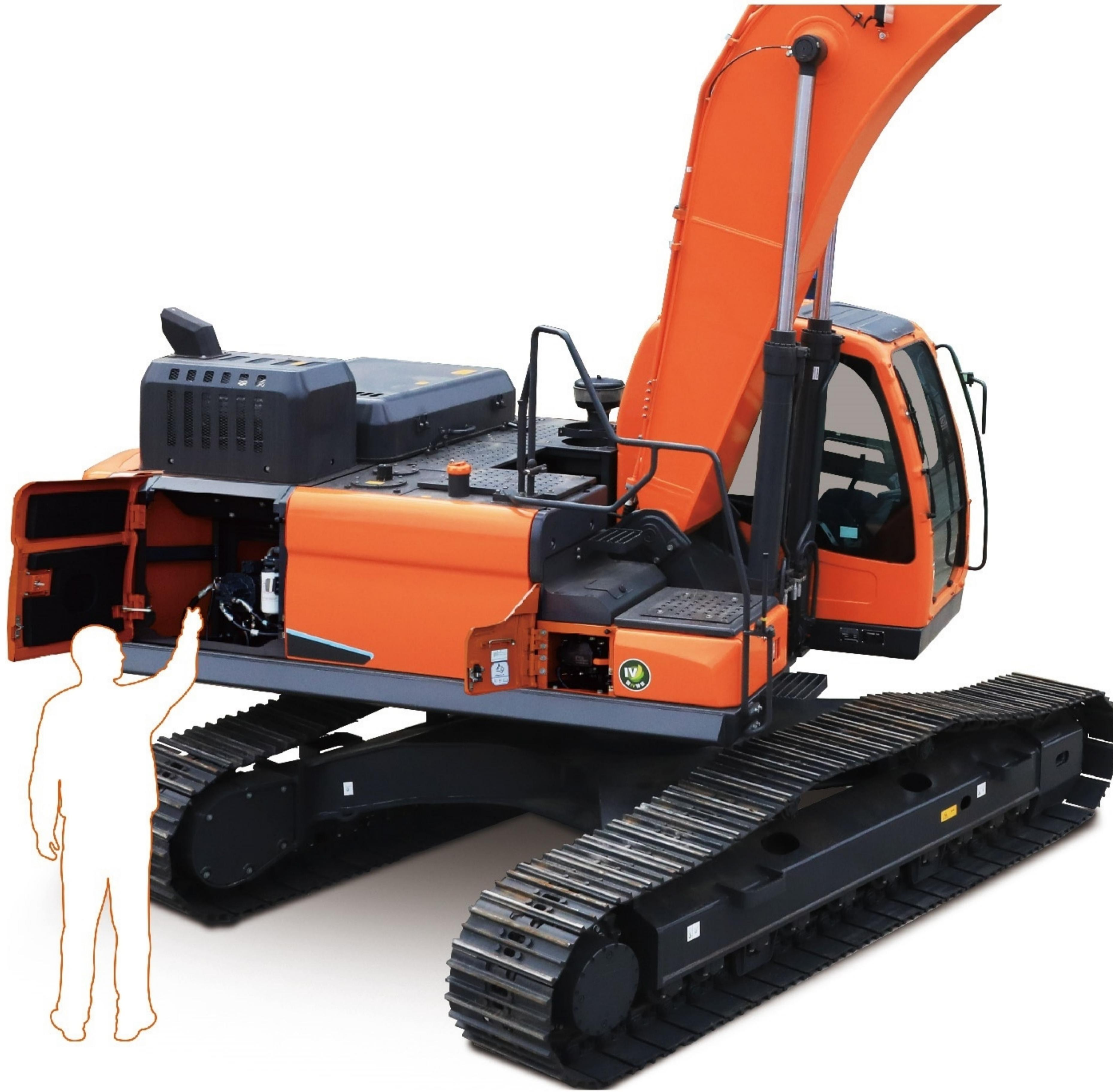
驾驶室侧维修通道滤芯集中布置, 增加维修的便利性。
